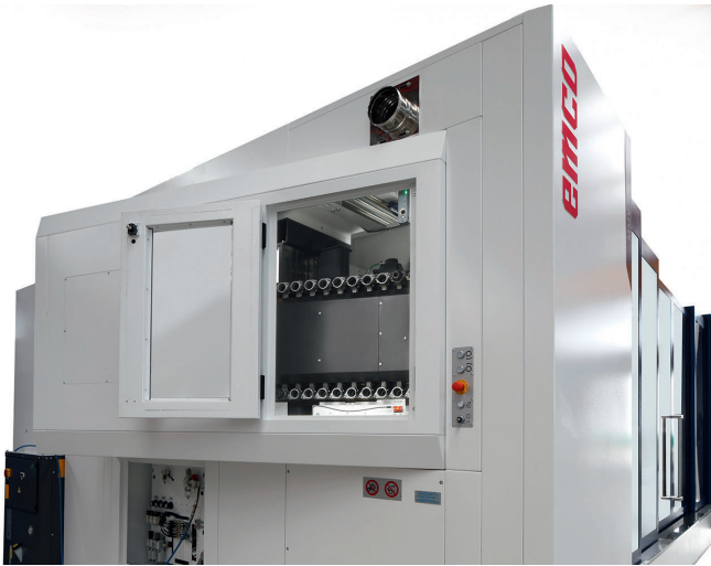
3 Blick auf das rechts angeordnete 60-fach-Werkzeugmagazin (hier beispielhaft verbaut an einer MMV 5200), das zusätzlich und optional zum links angeordneten 40-fach-Standard-Magazin integriert werden kann © Emco
